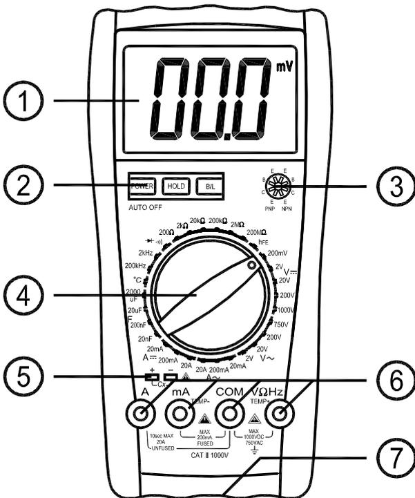
1. Жидкокристаллический дисплей, на котором отображаются измеренное значение и единица измерения.
