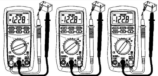
4.11.1 Вставьте штекер черного щупа в гнездо "COM", а красного в гнездо "INPUT", если измеряемый ток не будет превышать 200 мА.
